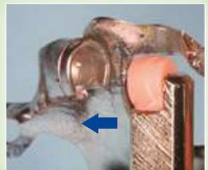
Inserção da capa no encaixe de aço **INOX** lateralmente
