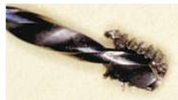
PARAFUSO QUEBRADO SENDO REMOVIDO
