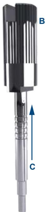
Broca de garrã (C) inserida na ferramenta manual (B) para remoção manual do parafuso quebrado
