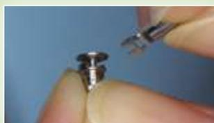
Insira a chave de bloqueio no guia de retenção e fixe-o com compósito.
