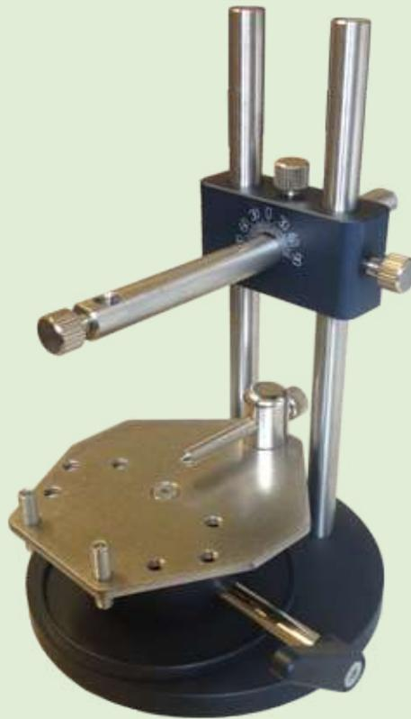
A função deste pequeno paralelômetro é fornecer ao técnico odontológico um dispositivo simples e pequeno que permite que a fixação seja aplicada sem o uso de brocadoras. Para determinar planos oclusais e outros. É adequado para cursos.
