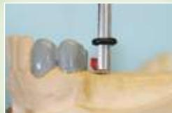
Insira o component **STEADY** na chave do paralelômetro (lado B) e coloque-o, encurtá-lo, se necessário.
