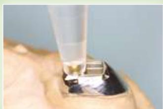
Coroa fundida, controlo de precisão com inserção de esfera de titânio na guia fundida com o instrumento apropriado
