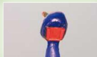
Coroa com base de guia calcinável com pino e prontas para a colocação em revestimento
