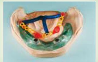
Adicione os jitos à estrutura e retire do modelo. Certifique-se de o encaixe de aço inox não fique dentro. A estrutura está pronta para o revestimento.
