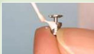
Aplicar o material compósito auto-endurecedor para parar a chave de bloqueio e inserir o pino de travamento no furo.
